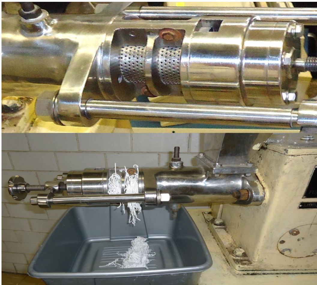
Figura 49 Ensamble de cedazo para flujo radial para la obtención de filamentos tipo "fideo"
