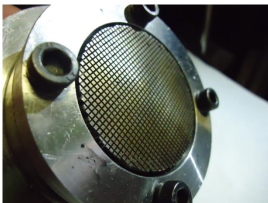
Figura 45 Soporte del dado para el proceso de electroerosión.
