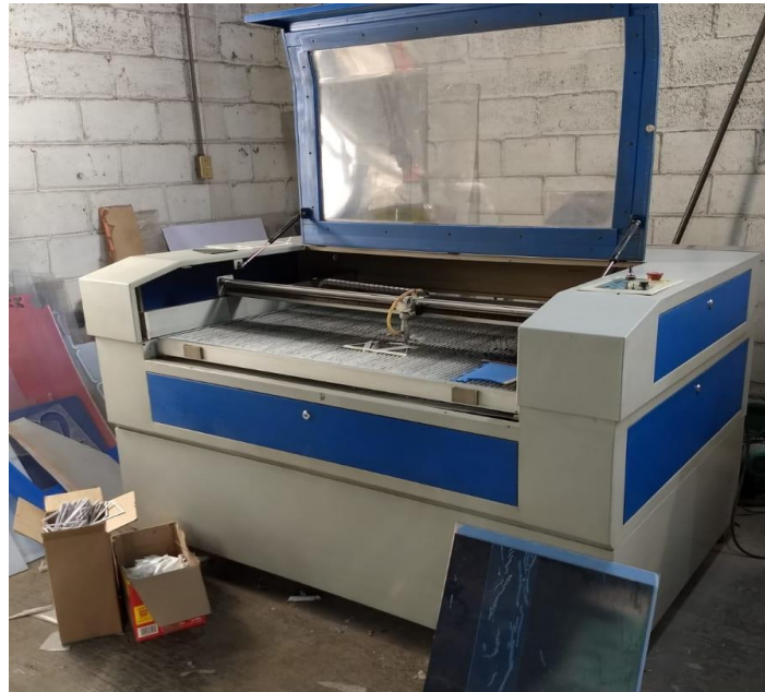
Imagen 5.2.1. Cortadora laser modelo 1200
