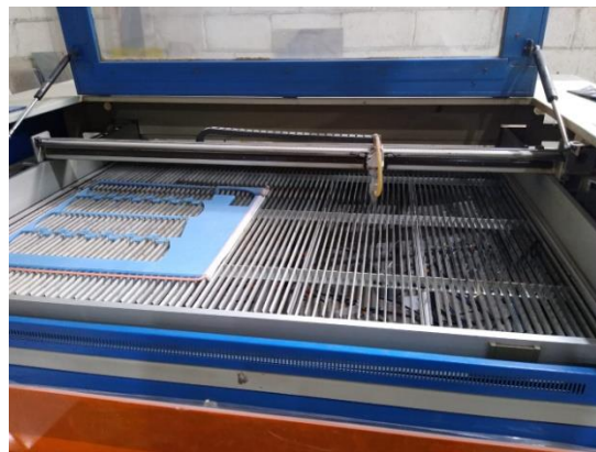
Imagen 5.2.7. Mesa de trabajo de cortadora laser, ejes X y Y
