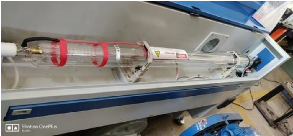
Imagen 5.3.123. Tubo de laser CO2
