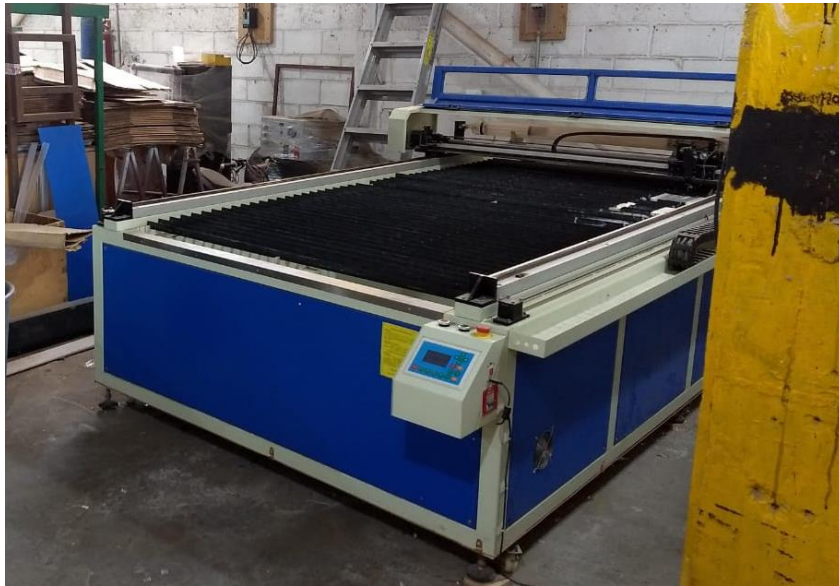
Imagen 5.3.1. Cortadora laser modelo 2440
