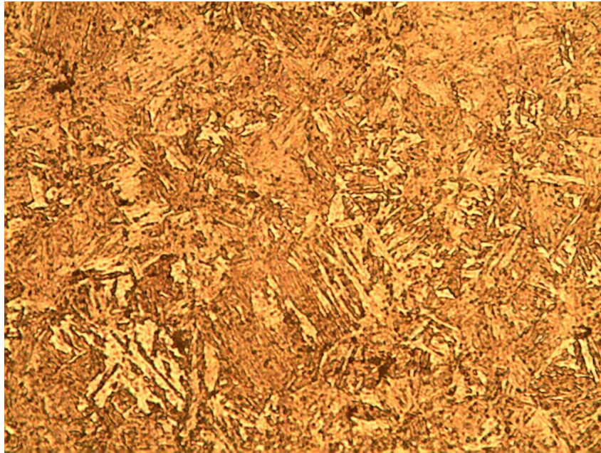
Figura 45.- Micrografía del núcleo de acero Cold Rolled cementado a 850°C x 8hrs, templado y revenido. Atacado con nital al 2% a 20X. Presencia de ferrita tipo widmanstatten mas perlita fina.
