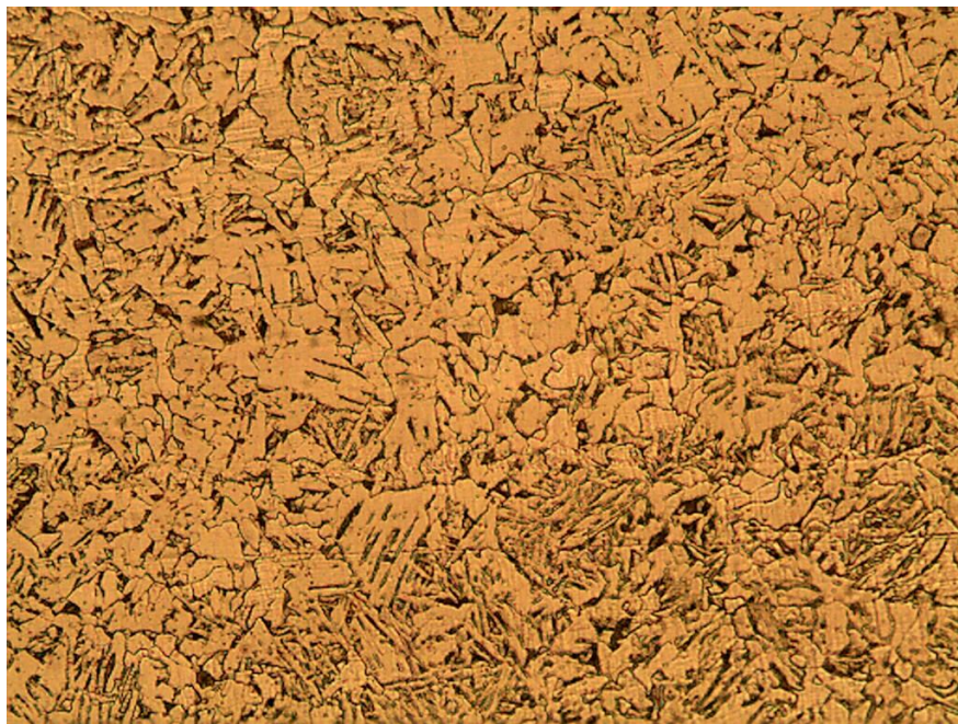
Figura 30.- Micrografía del núcleo de acero Cold Rolled tratado térmicamente a 950°C x 6hrs, con enfriamiento al aire. Atacado con nital al 2%, a 10X. Se observa la presencia de granos de perlita más ferrita tipo Widmanstatten.
