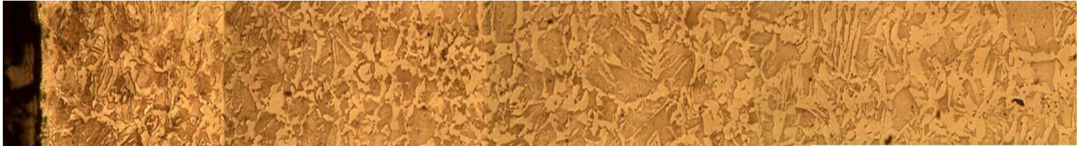
Figura 19.- Micrografía de la capa-núcleo del acero Cold Rolled tratado térmicamente a 850°C x 6hrs, con enfriamiento al aire. Atacado con nital al 2% a 20x.
