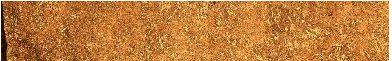
Figura 46.- Micrografía de capa-núcleo de acero Cold Rolled cementado a 850°C x 8hrs, templado y revenido. Atacado con nital al 2% a 20x.
