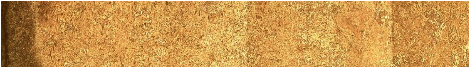
Figura 52.- Micrografía de capa-núcleo de acero Cold Rolled cementado a 950°C x 4hrs, templado y revenido. Atacado con nital al 2% a 20x.
