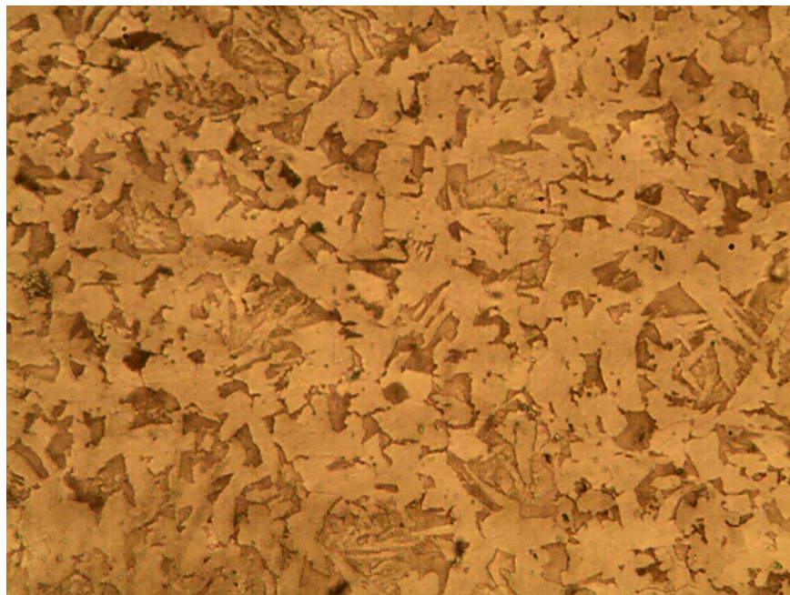
Figura 24.- Micrografía del núcleo de acero Cold Rolled tratado térmicamente a 850°C x 10hrs, con enfriamiento al aire. Atacado con nital al 2%, a 20X. Se observa la presencia de granos de perlita más ferrita tipo Widmanstätten.
