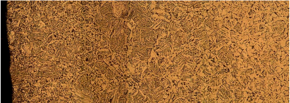
Figura 31.- Micrografía de la capa-núcleo del acero Cold Rolled tratado térmicamente a 950°C x 6hrs, con enfriamiento al aire. Atacado con nital al 2% a 10x.
