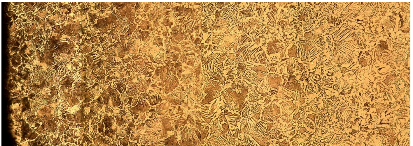
Figura 28.- Micrografía de la capa-núcleo del acero Cold Rolled tratado térmicamente a 950°C x 4hrs, con enfriamiento al aire. Atacado con nital al 2% a 20x.
