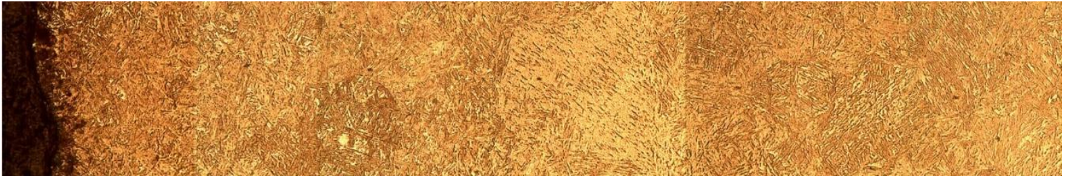
Figura 43.- Micrografía de capa-núcleo de acero Cold Rolled cementado a 850°C x 6hrs, templado y revenido. Atacado con nital al 2% a 20x.
