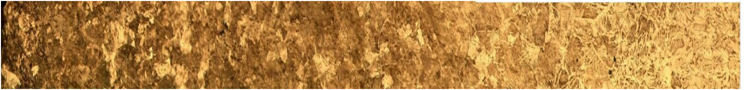
Figura 37.- Micrografía de la capa-núcleo del acero Cold Rolled tratado térmicamente a 950°C x 10hrs, con enfriamiento al aire. Atacado con nital al 2% a 20x.
