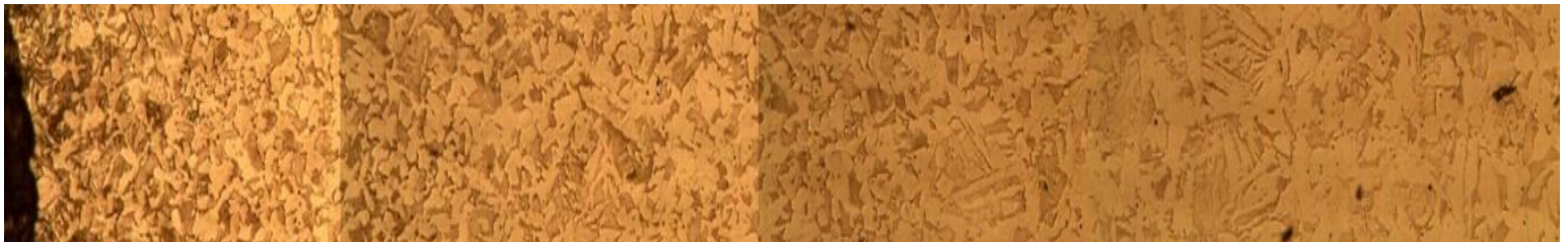
Figura 22.- Micrografía de la capa-núcleo del acero Cold Rolled tratado térmicamente a 850°C x 8hrs, con enfriamiento al aire. Atacado con nital al 2% a 20x.
