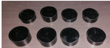
Figura 11.- Probetas, montadas en caliente en baquelita e identificadas.
