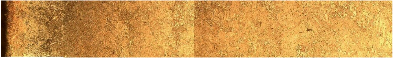
Figura 49.- Micrografía de capa-núcleo de acero Cold Rolled cementado a 850°C x 10hrs, templado y revenido. Atacado con nital al 2% a 20x.
