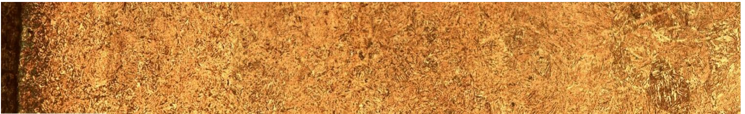
Figura 40.- Micrografía de capa-núcleo de acero Cold Rolled cementado a 850°C x 4hrs, templado y revenido. Atacado con nital al 2% a 20x.
