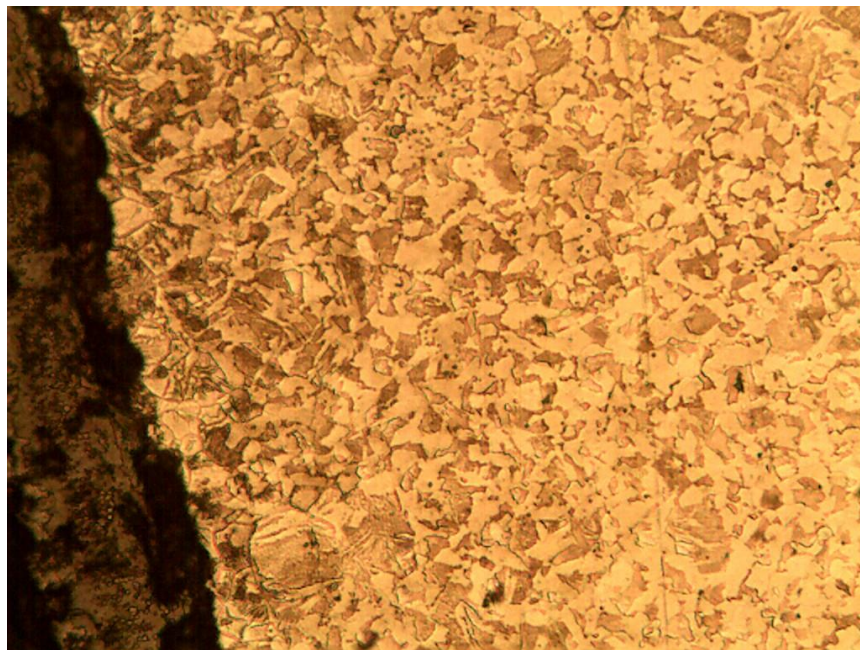
Figura 20.- Micrografía de capa cementada de acero Cold Rolled tratado térmicamente a 850°C x 8hrs, con enfriamiento al aire. Atacado con nital al 2%, a 20X. Se observa la presencia de granos equiaxiales de perlita con \text{Fe}_3\text{C} precipitada en los límites de grano.
