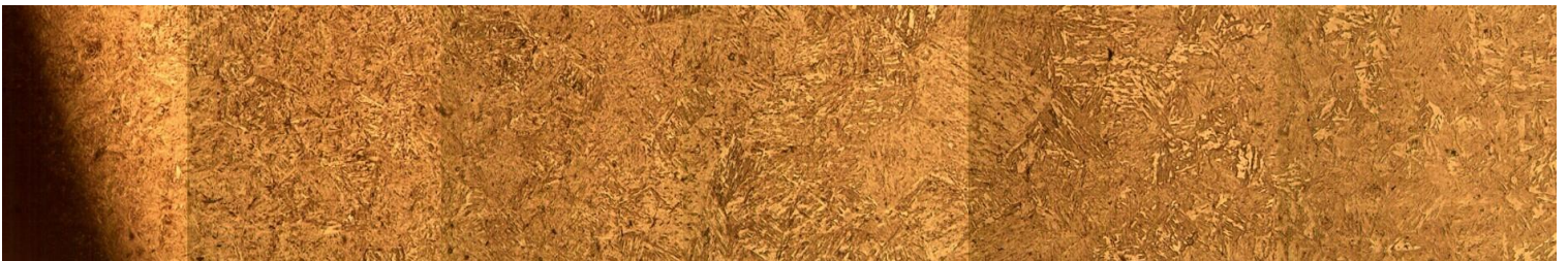
Figura 58.- Micrografía de capa-núcleo de acero Cold Rolled cementado a 950°C x 8hrs, templado y revenido. Atacado con nital al 2% a 20x.
