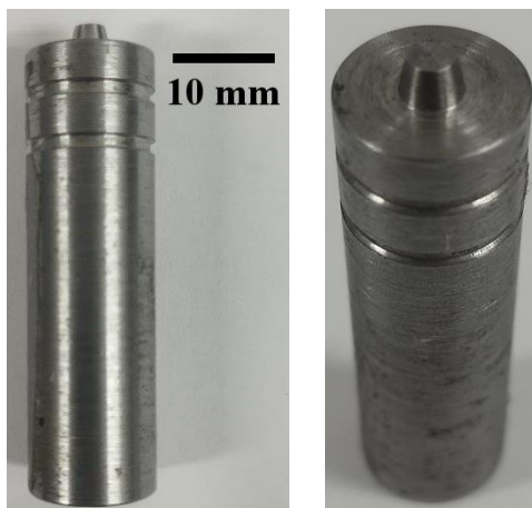
Ilustración 12. Herramienta giratoria de acero H13
