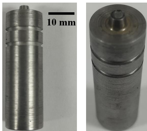
Ilustración 14. Herramienta giratoria de acero A11
