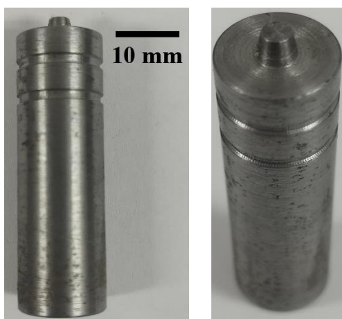
Ilustración 13. Herramienta giratoria de acero D2
