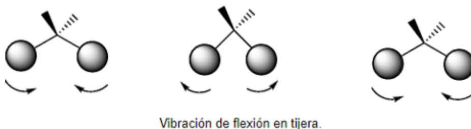
Figura 7. Vibración de flexión tijera
