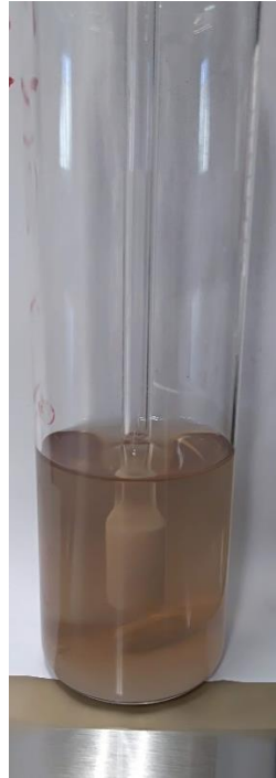
Figura 20. Solución de AA-NB a 50 ppm después de 2 horas en el reactor a pH básico
