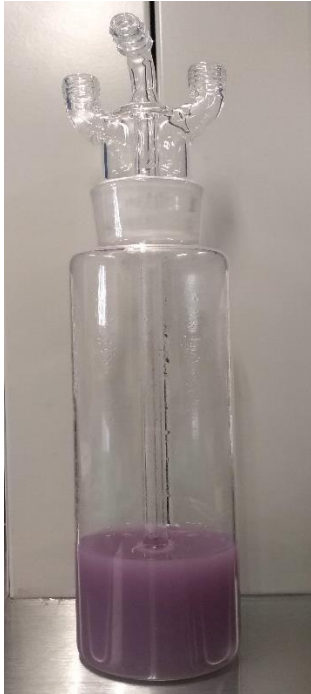
Figura 19. Solución de AA-NB a 50 ppm después de 2 horas en el reactor a pH natural
