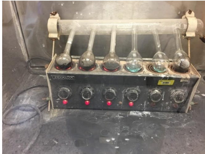
Figura 4.6 Equipo ensamblado para la prueba Kjeldahl
