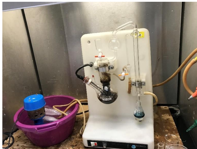
Figura 4.7 Equipo ensamblado para la destilación rápida
