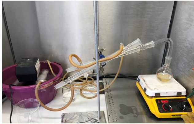
Figura 4.5 Ensamble para destilar el hexano y separarlo del combustóleo
