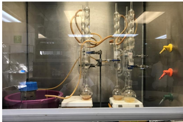
Figura 4.4 Ensamble del equipo para realizar la prueba Soxhlet para la extracción de los HTP
