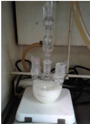
Figura 2. Síntesis del material ZnAl-HDL por el método de coprecipitación.
