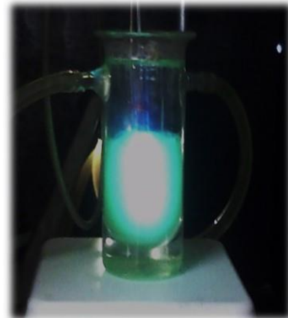
Figura 3. Reactor empleado en el proceso fotocatalítico de la reacción de degradación de 4-clorofenol.
