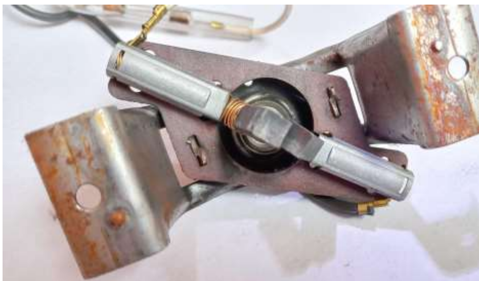
Figura 27. Carbones del motor de la licuadora Oster desgastados
