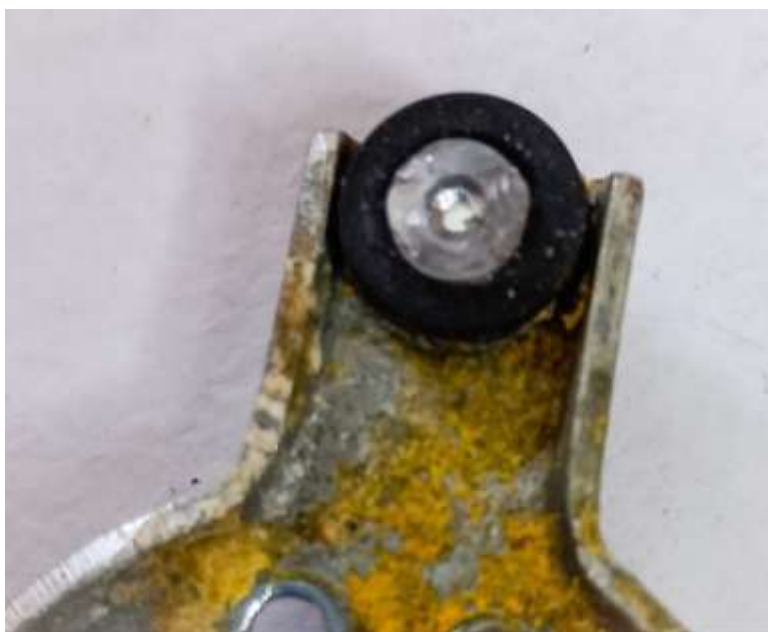
Figura 41. Vista de los bujes de la base interna de la licuadora NutriBullet
