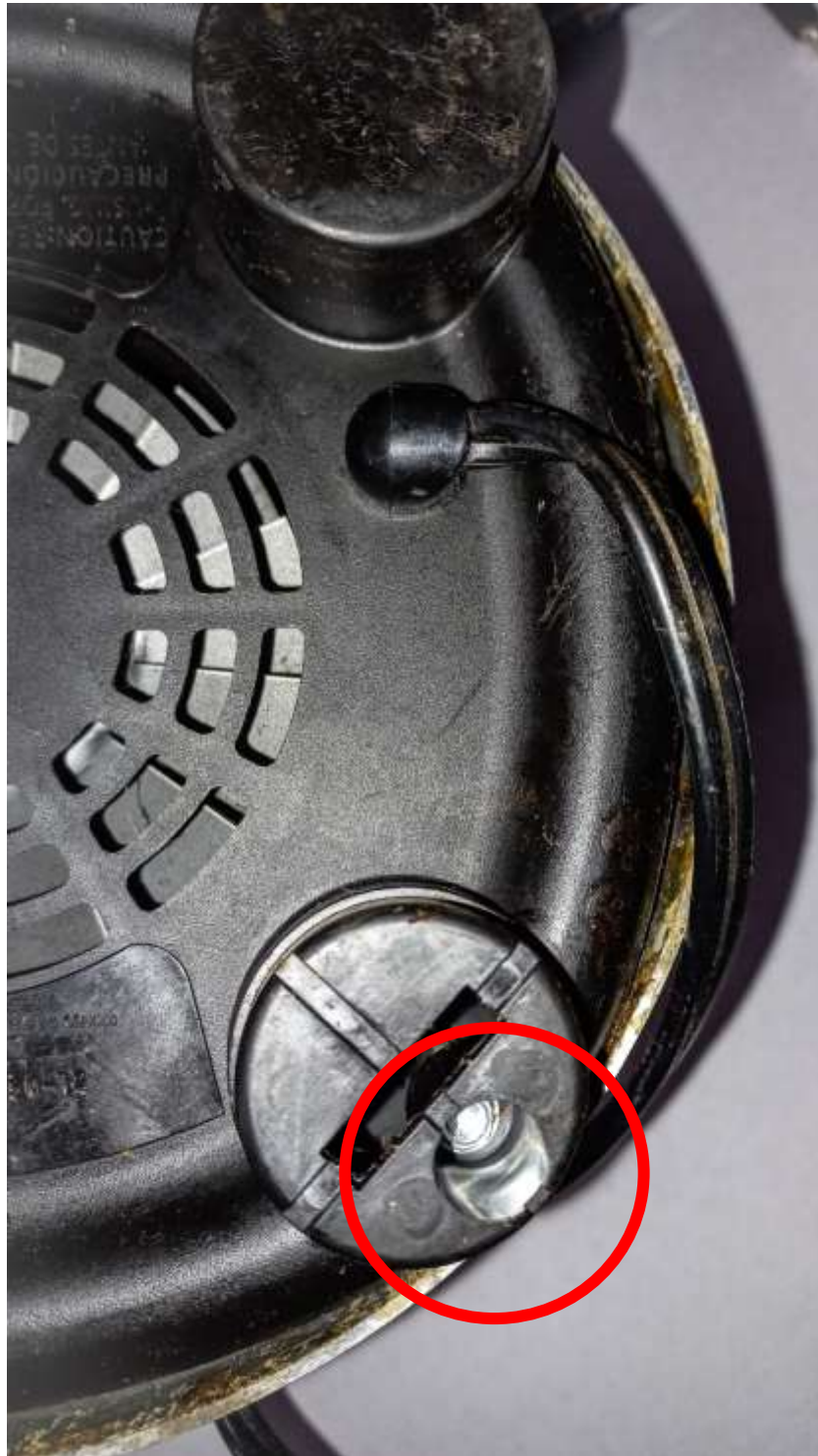
Figura 24. Tipo de unión de la tapa de la carcasa de la licuadora Oster
