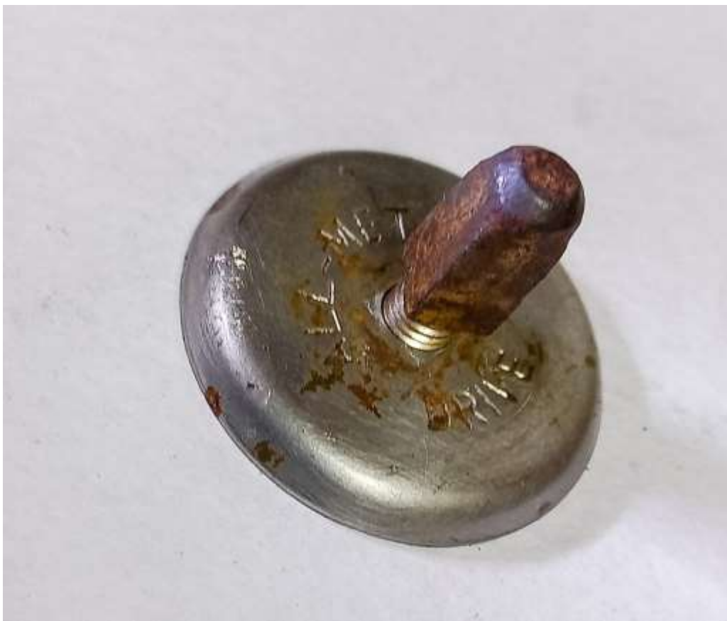
Figura 26. Cuadrete desgastado, oxidado y desviado de la licuadora Oster
