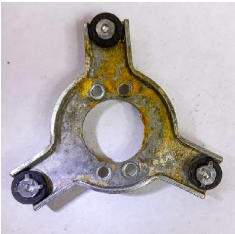
Figura 40. Base interna de la licuadora NutriBullet rota debido a los bujes
