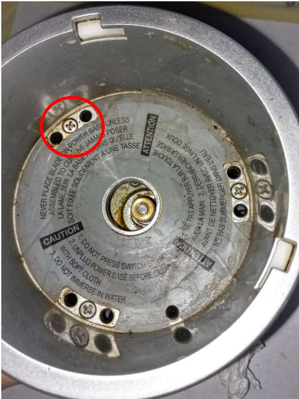
Figura 38. Base de la carcasa de la licuadora NutriBullet con sus tipos de uniones
