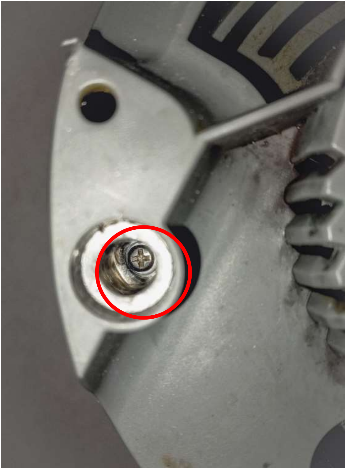
Figura 33. Tipo de unión de la licuadora Proctor Silex
