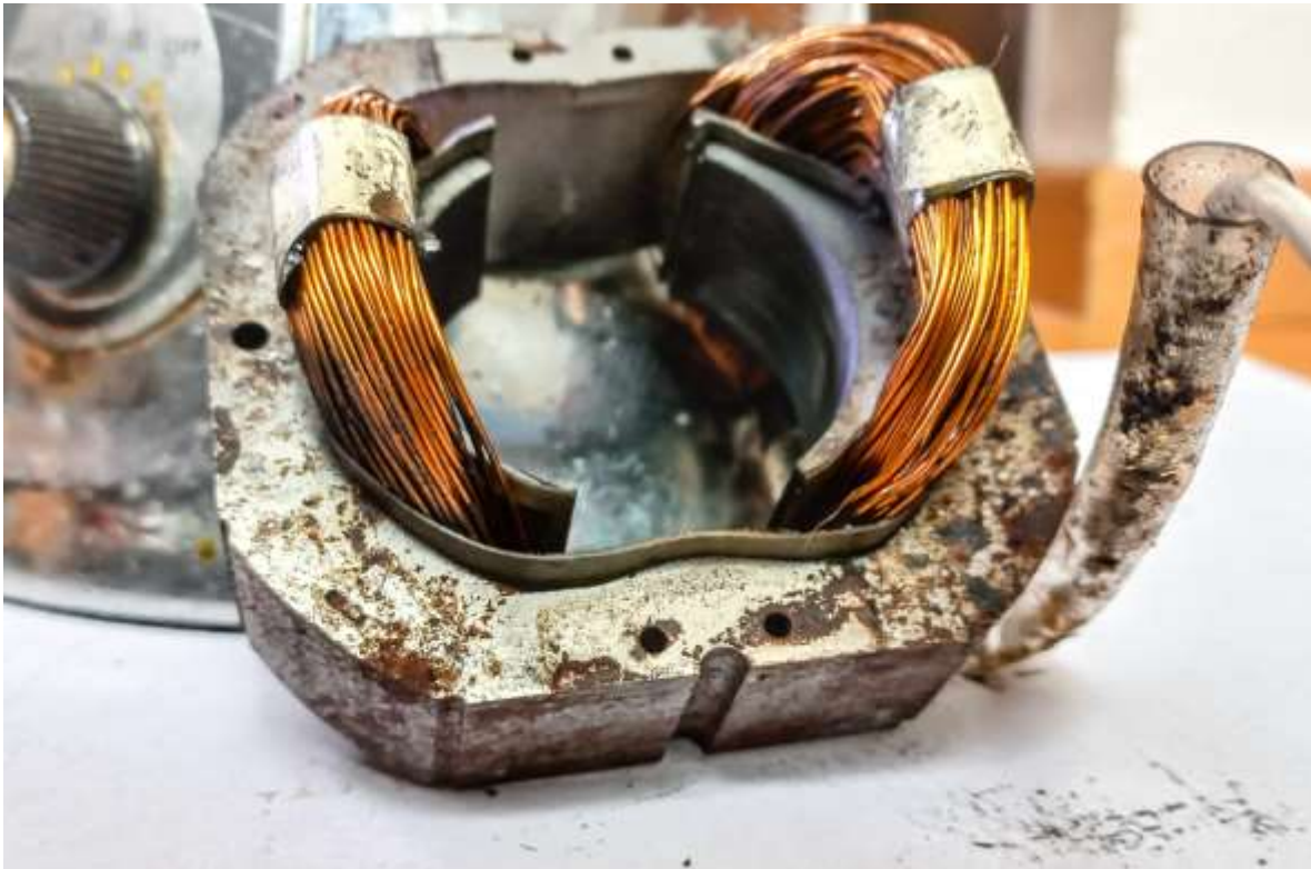
Figura 30. Campo ENS clásico de metal desgastado y quemado de la licuadora Osterizer
