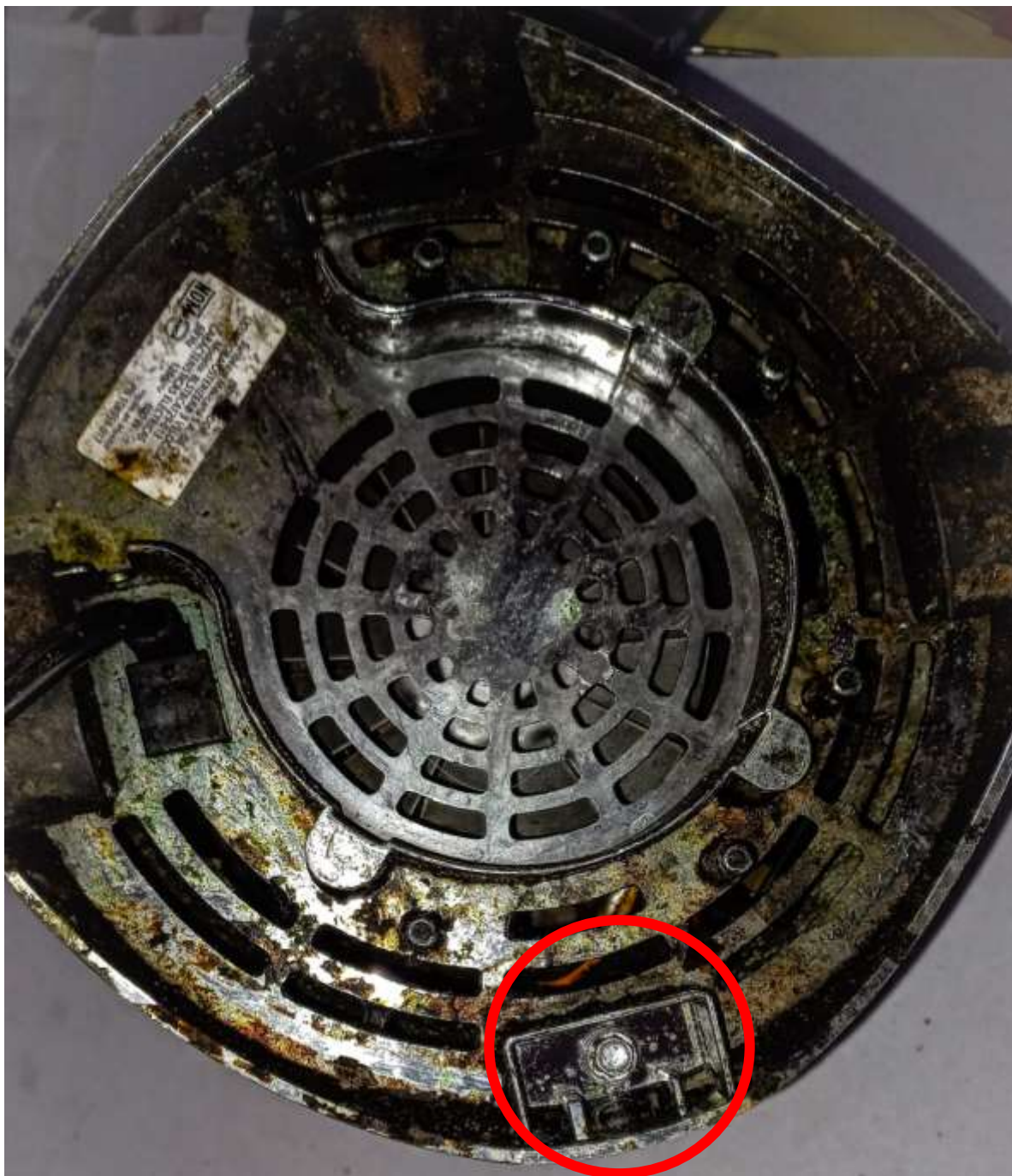
Figura 28. Tapa de la carcasa de la licuadora Osterizer con su tipo de unión
