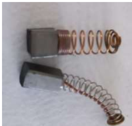
Figura 23. Carbones del motor de la licuadora Taurus desgastados
