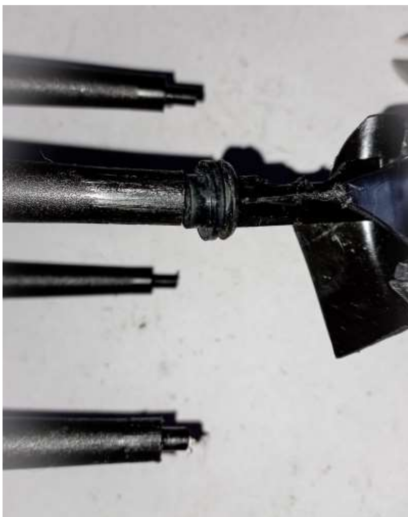
Figura 20. Unión de hule de la base con la tapa de la carcasa de la licuadora Taurus
