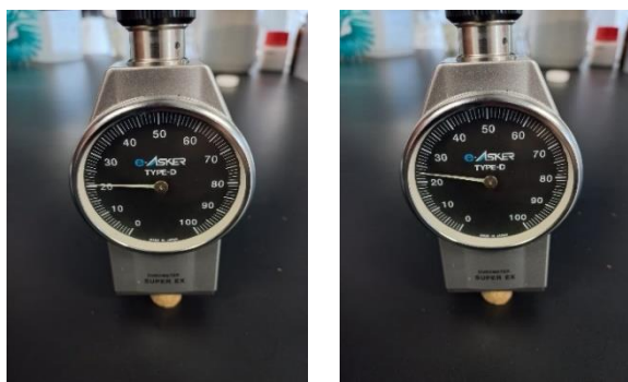
Figura 35. Registro de las medidas de dureza de la muestra compósito de 100% fibra de coco.
