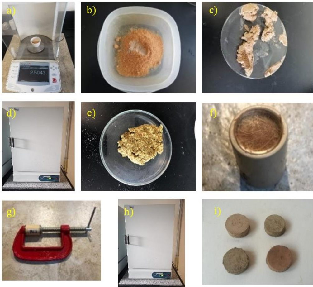
Figura 19. Esquema del proceso de síntesis de los composites. a) peso de la cantidad de arcilla y fibra, b) mezcla del compuesto, c) mezcla de la muestra con 12 ml de agua, d) secado a 90 °C por 1.5 horas, e) mezcla moldeable del compuesto, f) preparación de la muestra, g) proceso de prensado, h) secado a 30 °C por 2 horas i) muestras obtenidas.
