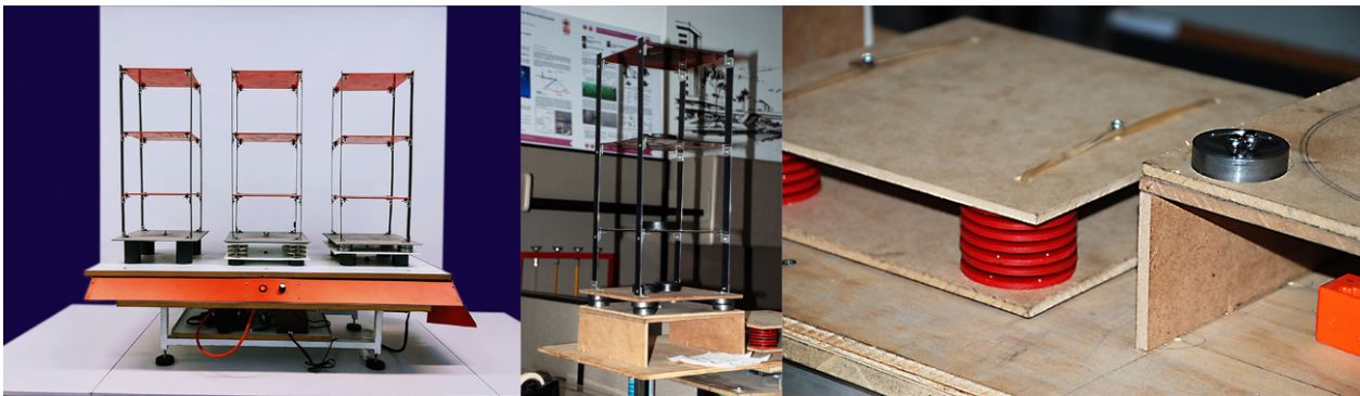
FIGURA 2. Proceso de diseño. Aparato SD 66 para demostración del principio de aislamiento de base en cimentaciones.
