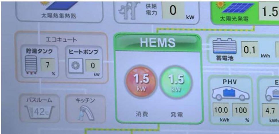
Figura 189. Concepto de casa inteligente en Japón con Home Energy Management Systems Figura 191 Concepto de casa inteligente en Japón con Home Energy Management Systems Link TV (2013). Japan: Smart Green Homes on the Horizon [imagen de video de youtube]. https://www.youtube.com/watch?v=gouul56oqwU
