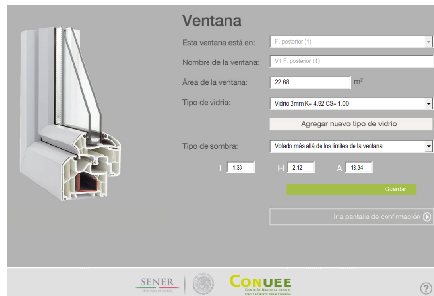
Figura 62. Captura de Datos de Ventanas en Fachada Posterior Fuente: Herramientas y Aplicaciones CONUEE
