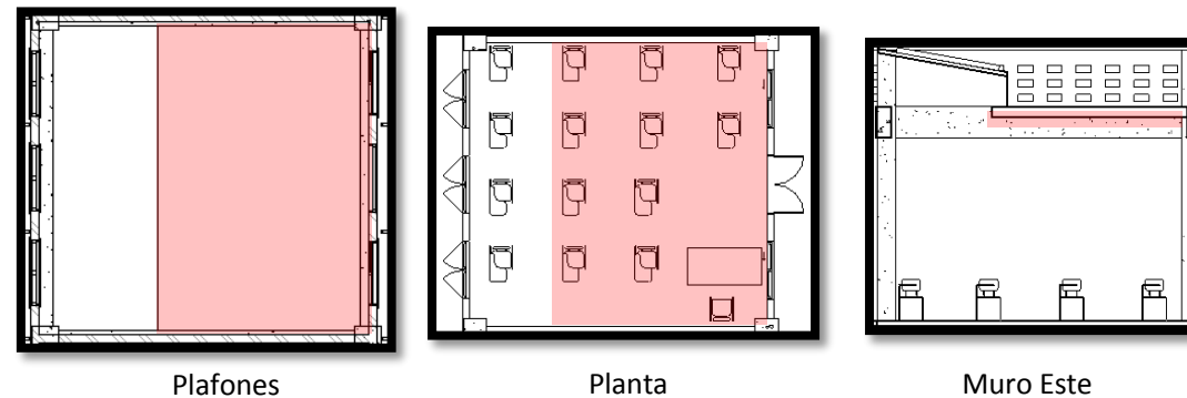
Figura 121. Ubicación de Plafón Ecophon Master E Fuente: Dibujo de Elaboración Propia
