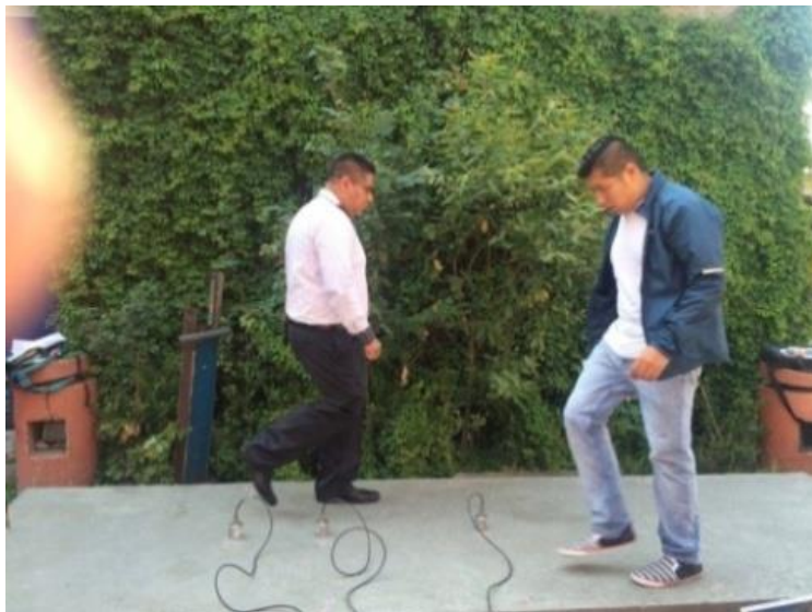
Figura 4.17. Prueba de vibración forzada debida al caminar de personas en losa apoyada en vigas.
