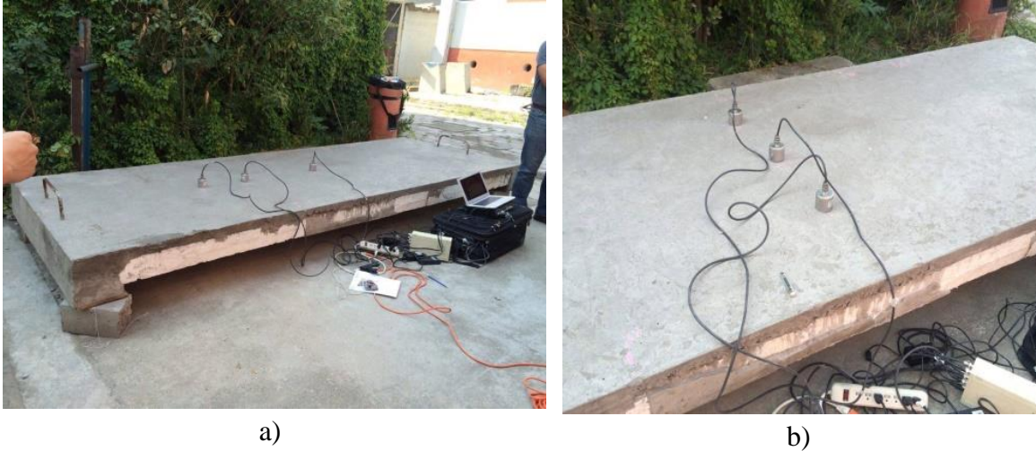
Figura 4.7. Ubicación de sensores en la PVL-LVB-AV. Arreglos: a) A1 y b) A2.
