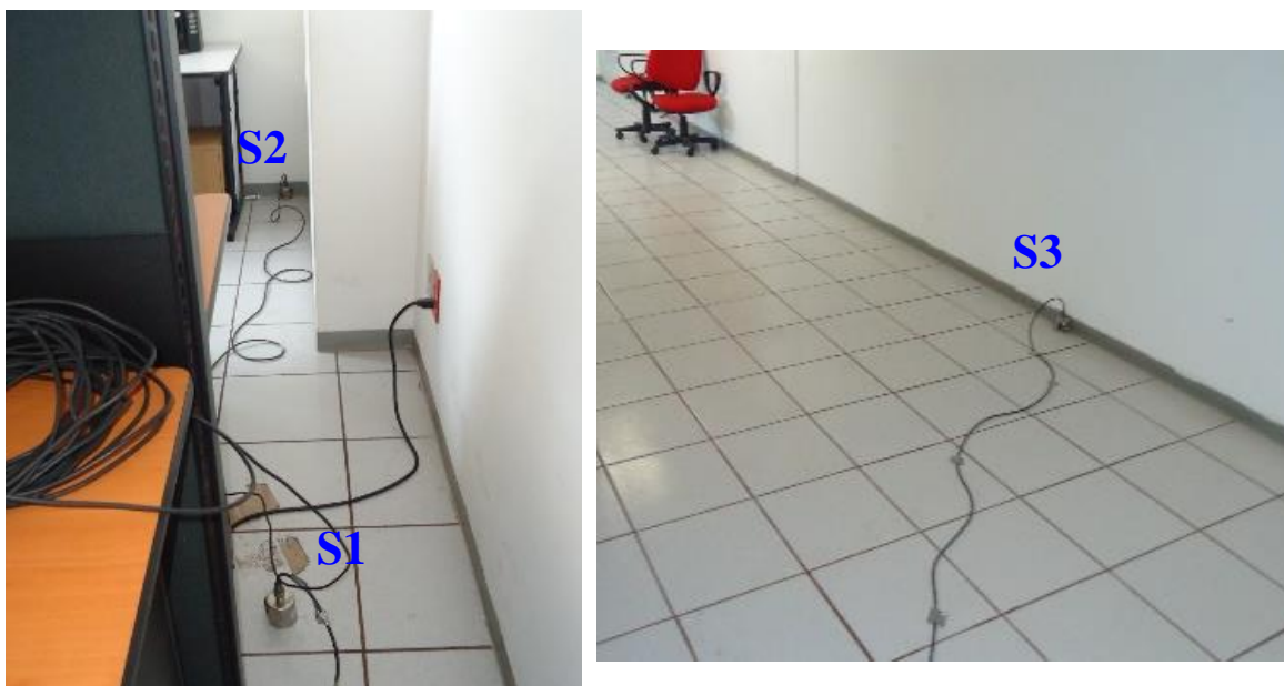
a) b) Figura 4.38. Sensores en la losa de prueba: a) S1 y S2 y b) S3
