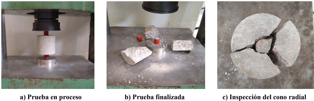
Figura A.5 Ensaye de doble perforación
