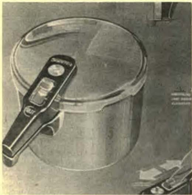
Fig. 2. Perspectiva realizada con tonos del mismo color del papel para definir la mayoría de las superficies y lápiz blando para las orillas y brillos. Esta técnica permite mantener al mínimo adiciones de color.
