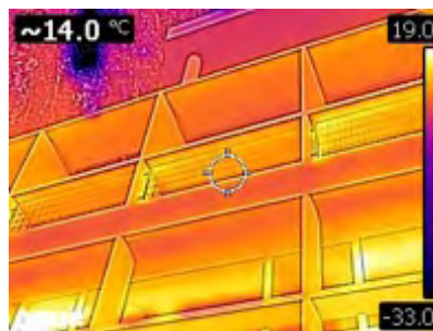
Figura 10. Imagen infrarroja de los parasoles (izq.), estudio de transmisión y reflexión de radiación solar y (der.) fotografía de la fachada exterior frente al sol (mayo 2018).
