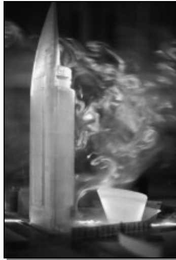
Figura 19: Modelo a escala, técnica de visualización con humo. Edificio del World Trade Center,
