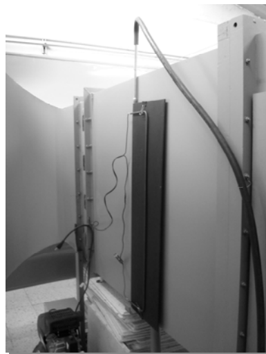
Figura 48: Imagen ilustrativa, pruebas con el peine de humo de 0,98m x 0,28m.
