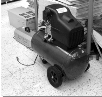
Figura 49: Compresora de aire, marca Goni, modelo 977. De 3.5 HP y una capacidad de 40 Lt de aire.
