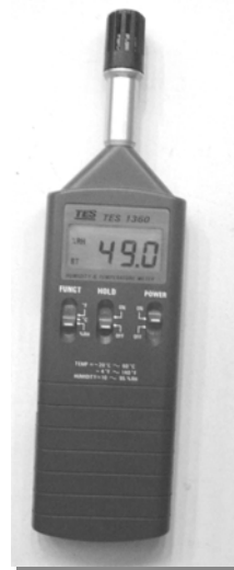
Figura 57: Termo-Higrómetro. Marca: TES. Modelo 1360. Magnitud: Temperatura /Humedad. Tipo: Digital. Rango de medición: 10% a 95% humedad; 20 °C a +60 °C temperatura. Resolución mínima: 0.1% humedad. 0.1 °C temperatura.
