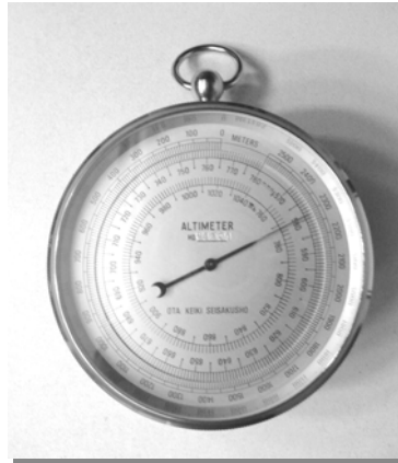
Figura 56: Barómetro. Marca: OTA Keikiseisakisho. Magnitud: presión barométrica. Tipo: Analógico. Rango de medición: 488 a 788 mmHg. Resolución mínima: 1 mbar = 0.75 m.
