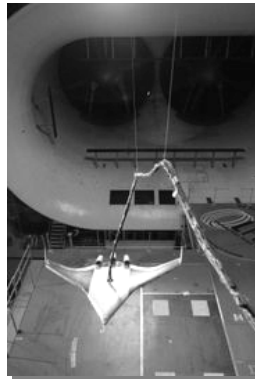
Figura 12: Imágenes ilustrativas de un modelo a escala de un avión dentro de Túnel con una sección de prueba elíptica y circular.
