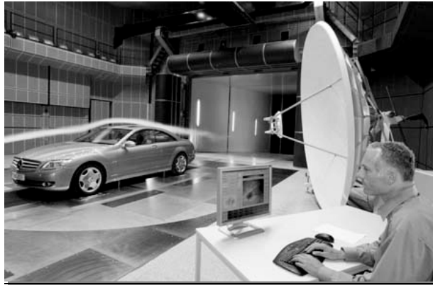
Figura 13: Estudio aerodinámico de carrocerías con técnica de visualización con humo.
