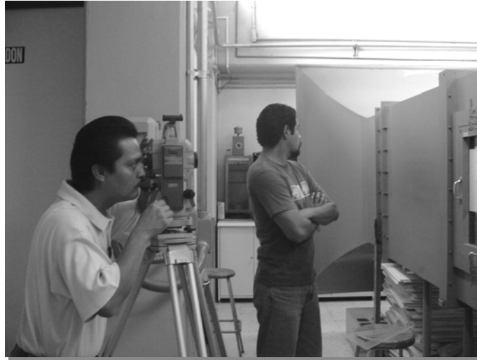
Figura 40: Con el apoyo un sistema de posicionamiento global, que permite establecer impecablemente alineados los puntos para las perforaciones en las ventanas de la sección de pruebas.
