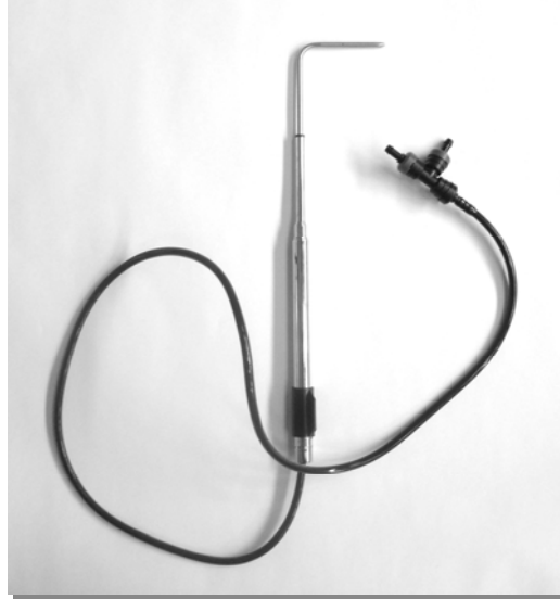
Figura 58: Tubo Pitot Estático Tipo L. Marca: Air Flow. Material: Acero inoxidable. Diámetro:4mm. Nariz: Elipsoidal. Coeficiente de corrección: 0.85
