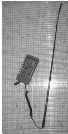
Figura 63: Anemómetro. Marca Air Flow . Modelo TA5 Permite hacer lecturas de la velocidad y la temperatura, digitales y almacenaje de hasta 30 datos. El periodo de estabilización para cada punto fue de 1min.
