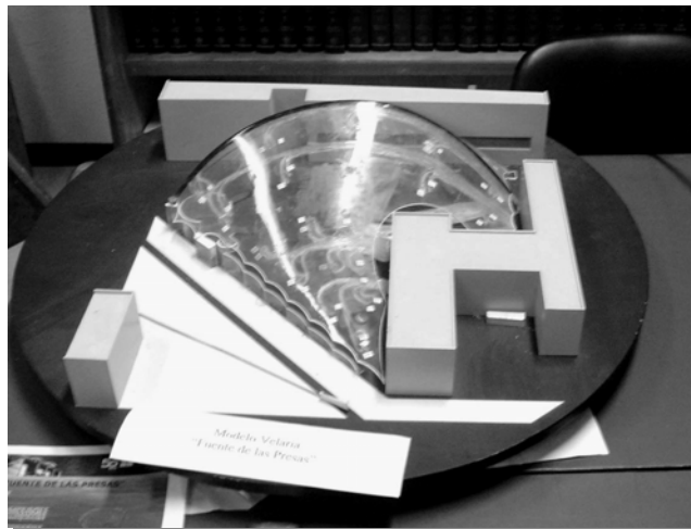
Figura 18: Detalle de un modelo a escala para estudio de presiones, en Universidad Autónoma de México, Facultad de Ingeniería.
