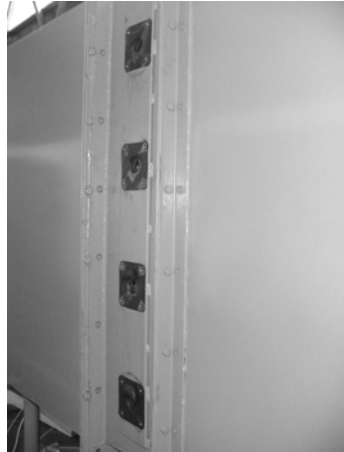
Figura 39: Costado lateral derecho del túnel sin la palanca de acción para las persianas.
