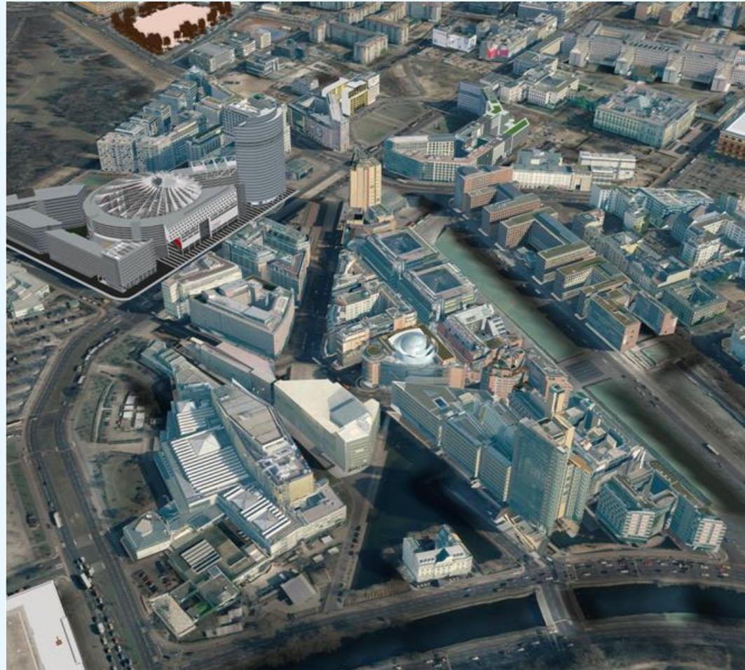
**Se estudia:** Orientación de calles en relación con las energías naturales./La posición de los volúmenes edificados./La capacidad térmica de los materiales constituyentes y su permeabilidad./ Rugosidad y porosidad de la estructura urbana./Proporción entre alturas de los edificios y espacios existentes
