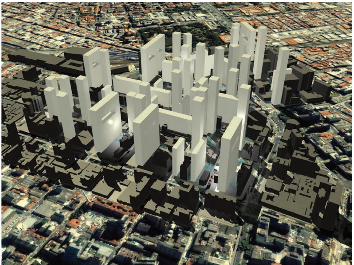
Figura 7. Proposta de adensamento com a inserção de edifícios novos (torres e lâminas), separados dos existentes e afastados dos limites das calçadas, no bairro da Luz, centro de São Paulo (Gonçalves, et. al. , 2011a; Gonçalves, et. al. , 2011b).
