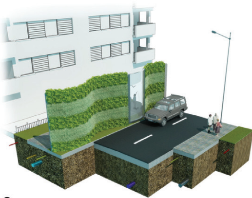
Figura 45. Pantallas acústicas verdes: 1. Paredes verdes con base de gaviones, 2. Paredes verdes a base de paneles vegetales, 3. Paredes verdes de fieltro.
