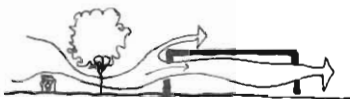
fig. 122 setos y árboles alejados, provocan que parte del flujo "escape" hacia arriba.
