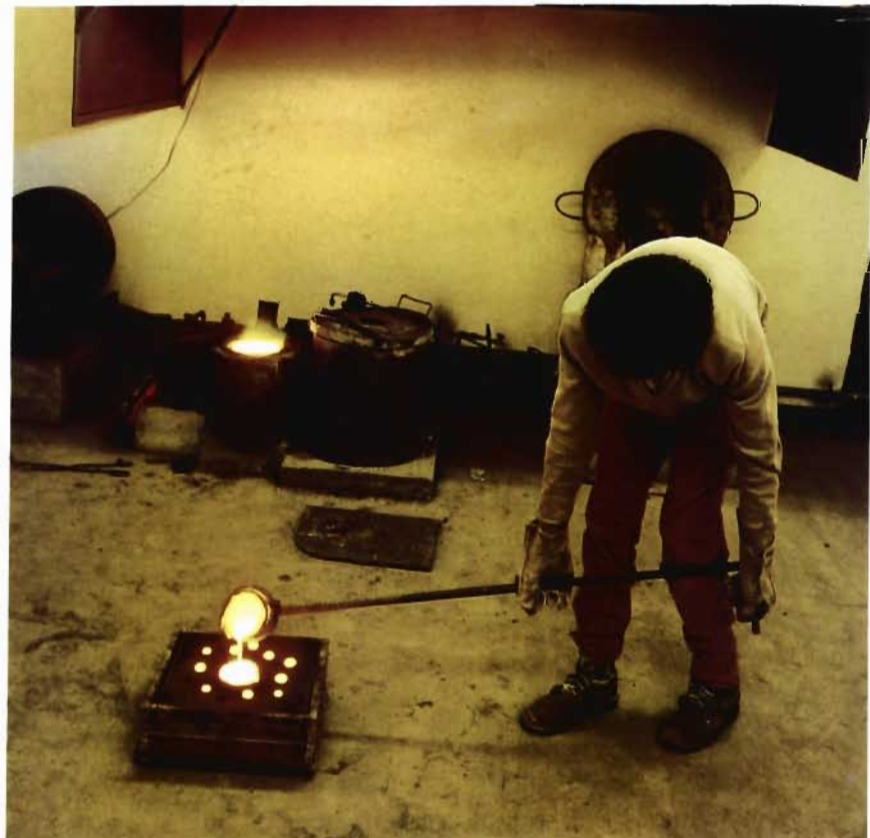
Un estudiante del Cecati No. 166 vaciando cobre fundido de un crisol a un molde de arena
