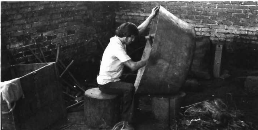
Martillando un cazo del interior, so- bre un yunque de fierro, colocado de la misma manera que los antiguos de piedra
