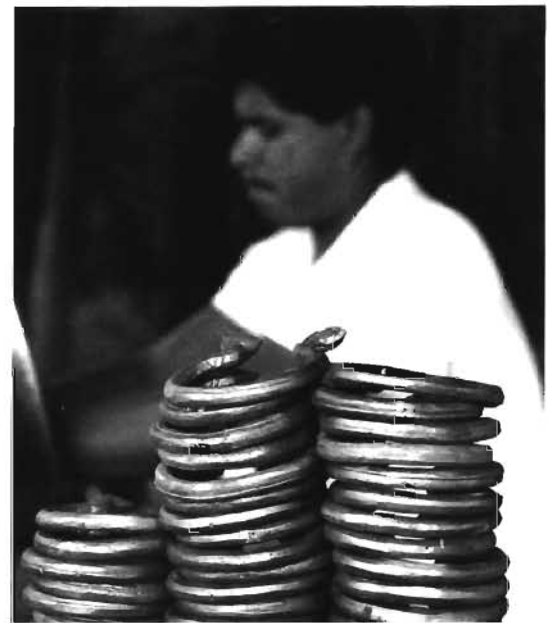
Acumulación de asas de cobre forjadas, listas para ser remachadas en los cazos
