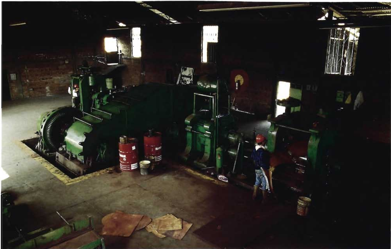
Tren de laminadoras activado por un motor central de grandes dimensiones
