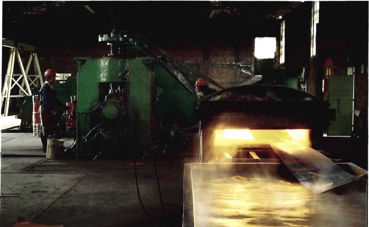
Recalentando la lámina de cobre para continuar adelgazándola
