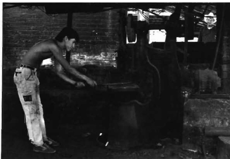
Artesano forjando las tiras de cobre para las asas de los cazos, en un martinete mecánico de herrero
