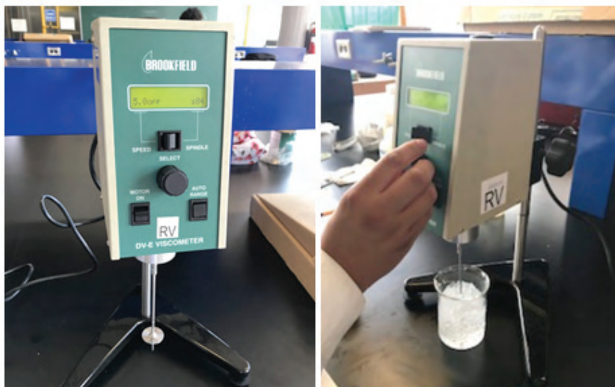
Figura 9. Pruebas realizadas a las muestras utilizando un viscosímetro digital Brookfield. Fuente: elaboración propia.
