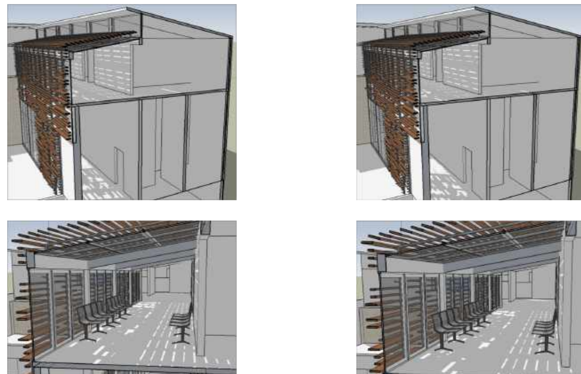
Figura 92 y 93 . Incidencia solar a las 14:00 y 15:00 horas en el mes de marzo. Fuente: Elaboración propia
