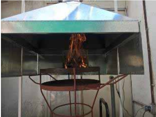
Figura 14. Quema de residuos de algodón en el quemador de UAM-Azcapotzalco
