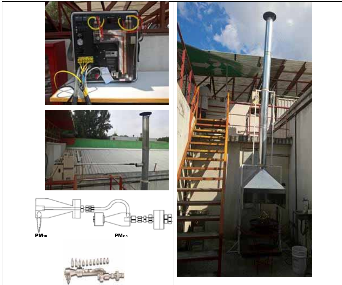
Figura 13. Equipo Apex para el muestreo isocinético de partículas en el quemador de residuos de la UAM-Azcapotzalco
