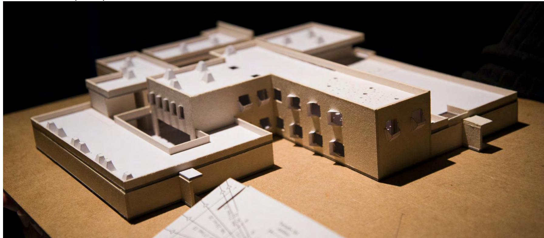
Imagen 94. Maqueta para evaluación dispositivos de sombreado
