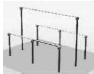
Ilustración 23. Sistema estructural de apoyo estructural de torito con pie derecho. Fuente: Adecuación al medio ambiente de la arquitectura del Siglo XVIII en la Antigua Provincia de Colima.
