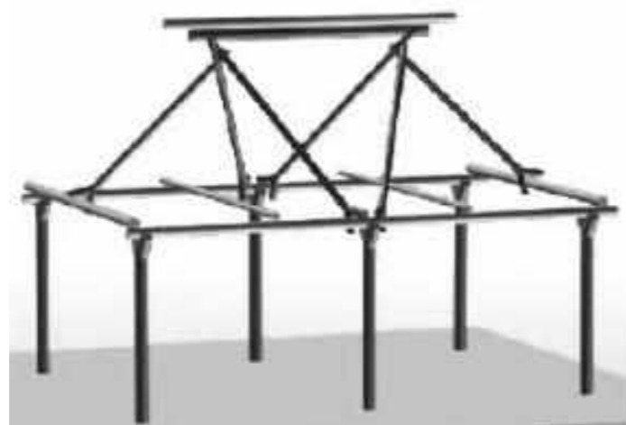
Ilustración 33. Disposición de elementos estructurales en una estructura para cubierta de pata de gallo. Fuente: Adecuación al medio ambiente de la arquitectura del Siglo XVIII en la Antigua Provincia de Colima.
