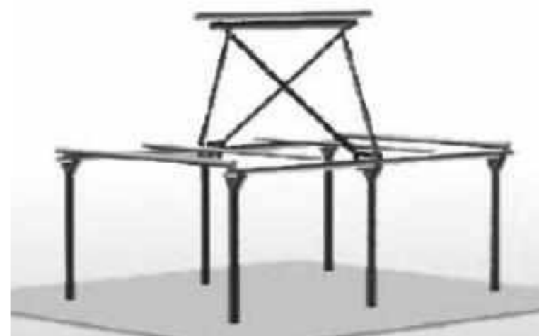
Ilustración 34. Disposición de elementos estructurales en una estructura de tijera. Fuente: Adecuación al medio ambiente de la arquitectura del Siglo XVIII en la Antigua Provincia de Colima.
