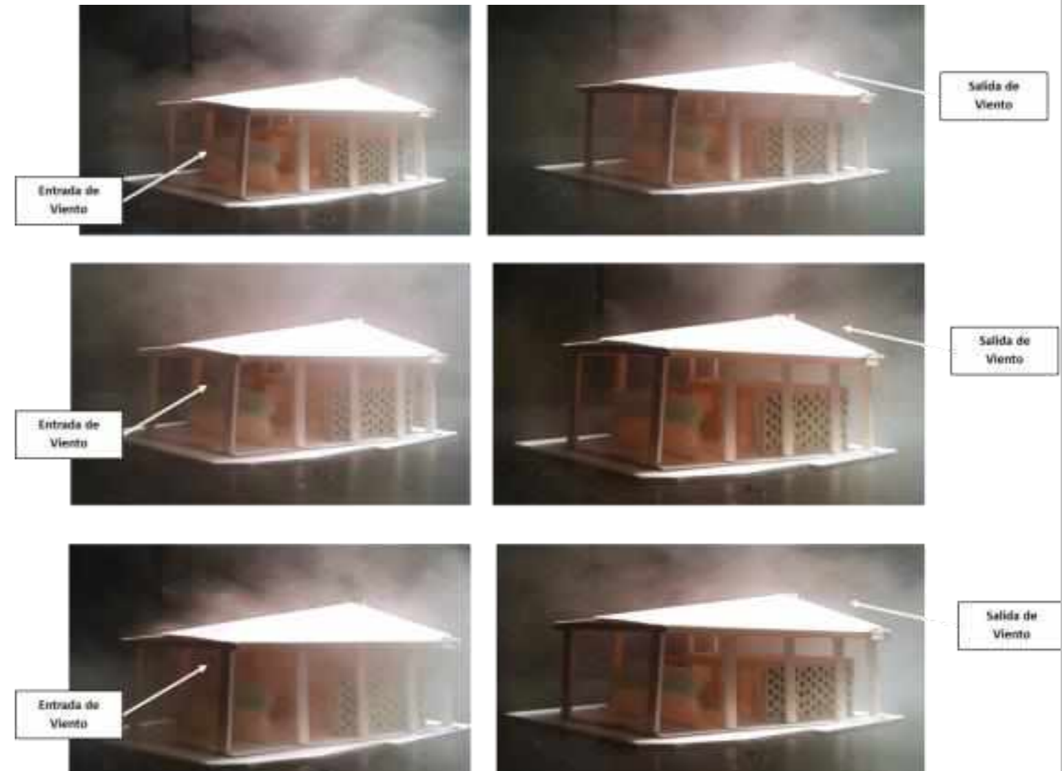
Ilustración 104. Comportamiento de viento en el refugio, entrada y salida de viento. Fuente: Auditoría propia.
