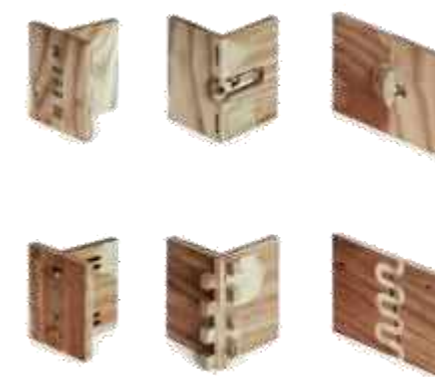
Ilustración 126. Uniones para placas de cedro propuestas. Fuente: Google images.
