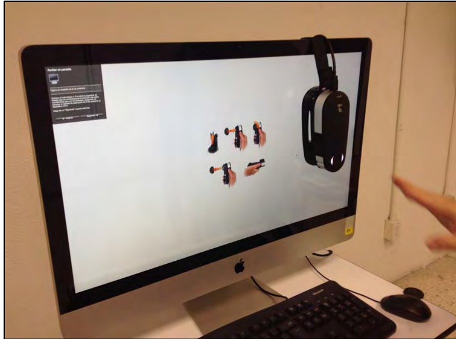
Figura 90. Foto de la calibración del monitor dentro del laboratorio de iluminación artificial.
