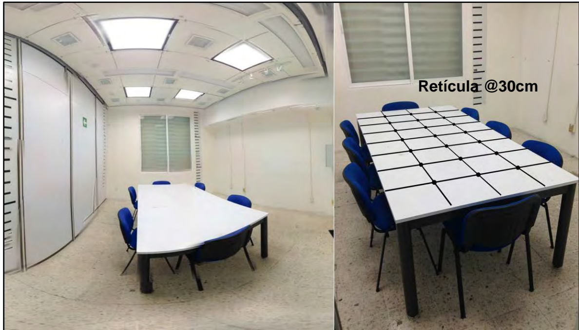
Figura 73. Foto del LIA con mesa y retícula a cada 30 centímetros donde se ubicó el luxómetro.
