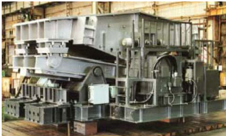
Figura 1.13. HMD tipo V instalado en la torre Shinsuku Park en Japón
