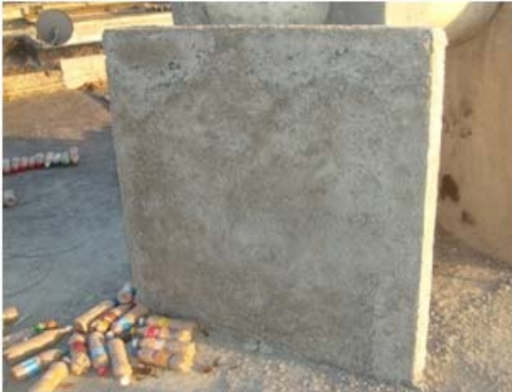
Figura 3.18 Panel de 1.22x1.22m con aplinado.
