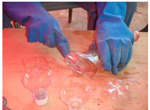
Figura 3.8 Corte del fondo de botella.
