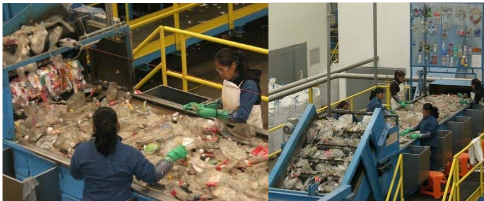
Figura 1.20 Retiro de etiquetas en botellas de pet.
