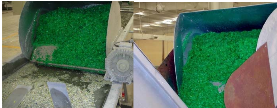
Figura 1.21 Lavado y secado de hojuelas de pet.
