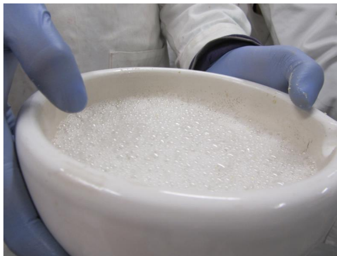
Figura 1. Obtención de espuma a partir del extracto de M. helleri , como prueba fitoquímica de la presencia de saponinas.
