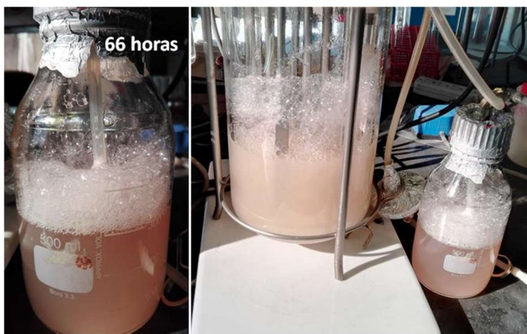
Figura 17. Aspecto de la espuma y el biorreactor a 0.80 vvm a las 66 horas de cultivo
