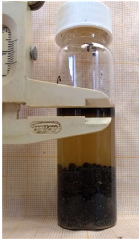
Figura 5. Determinación del volumen de aceite liberado por medición del espesor de la capa formada en la superficie
