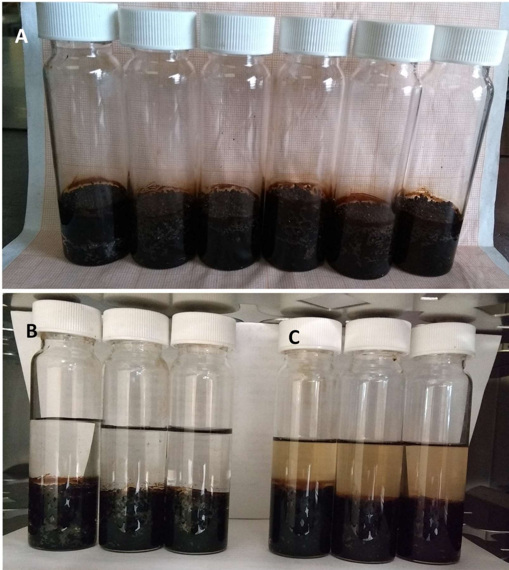
Figura 21. Aspecto de las columnas para los ensayos de liberación de aceite. A) Arena impregnada con el aceite pesado B) Columnas control con agua destilada y C) Columnas con el biosurfactante
