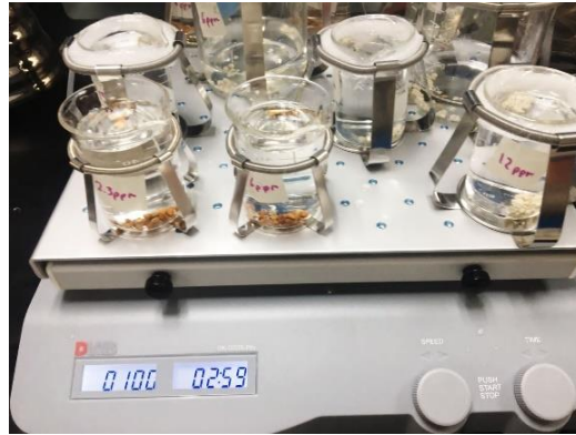
Figura 6. 7. Isothermas de adsorción realizadas con un agitador orbital
