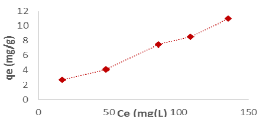
Figura 6. Isotherma de adsorción de Pb (II) sobre bagazo de coco, pH=5.5 y concentraciones altas.
