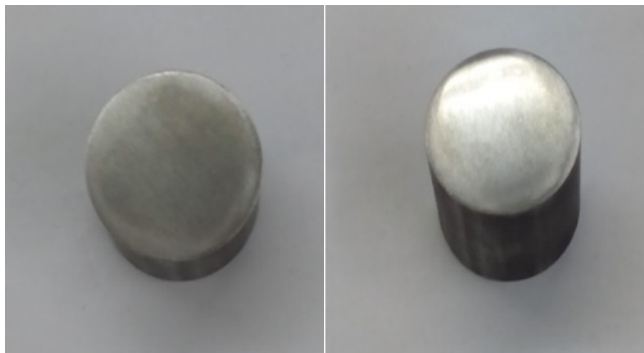
Figura 3. La imagen muestra una vista de la misma superficie antes y después del electropulido.
