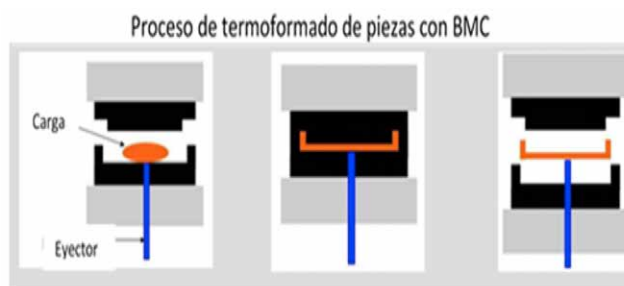
Figura 1. Esquema del proceso de termo compresión para fabricar piezas con BMC
