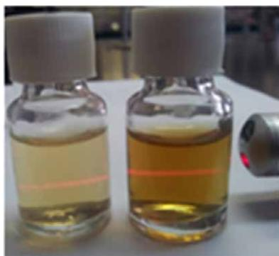
**Figura 1.** Cambio de color de las soluciones. Solución antes del proceso de reducción y luego de completarse el proceso de reducción.
