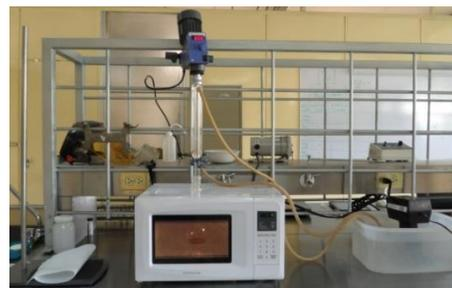
**Figura 4.** Síntesis y condensación del polímero mediante microondas. (Villaseca, 2019).
