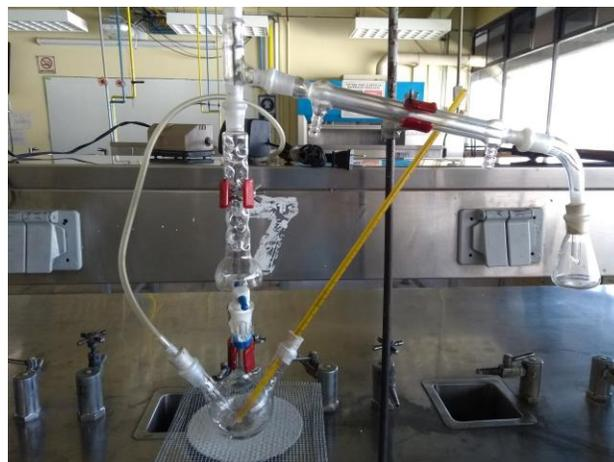
**Figura 1.** Montaje del equipo para la oxidación de aldehídos (Villaseca Alonso y Miguel Cruz, 2019).
