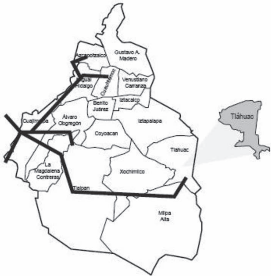
Figura 4. Esquema del suministro de agua a la Ciudad de México. Fuente: Luis Galicia Chacón et al. , “Análisis de la concentración de fluoruro en agua potable de la delegación Tláhuac, Ciudad de México”, en Revista Internacional de Contaminación ambiental , vol. 27, núm. 4, México, noviembre de 2011, disponible en: < http://www.scielo.org.mx/scielo.php?script=sci_arttext&pid=0188-49992011000400001 >.
