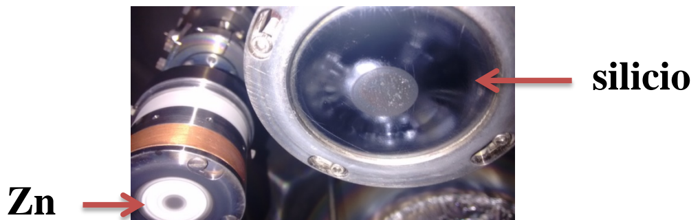
Figura 2.3 Arreglo de blancos de Zn (izquierda) y silicio (derecha) en el equipo de RF-sputtering.
