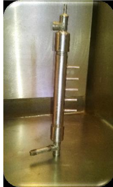
Figura 15 Reactor previo a empaque catalítico [2]
