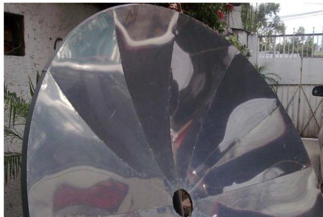
Figura 3 Paraboloide final con material reflejante Reflec Tech. [3]
