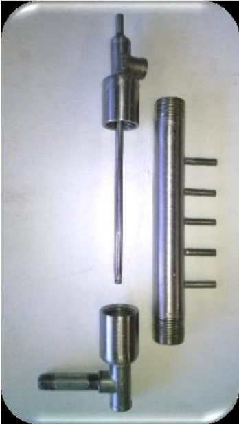
Figura 14 Reactor tubular para ESR. [2]
