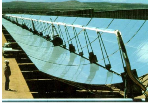
Figura 7 Concentrador de canal parabólico de las plantas SEGS, en Kramers Junction, California, EUA.
