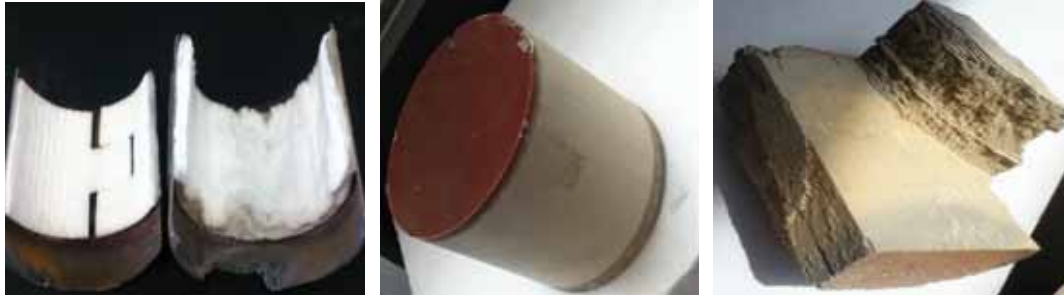
Figura 4. Carcasa de Hierro del Convertidor catalítico completo, Cerámica de CCA del Lote I. (NISSAN)
