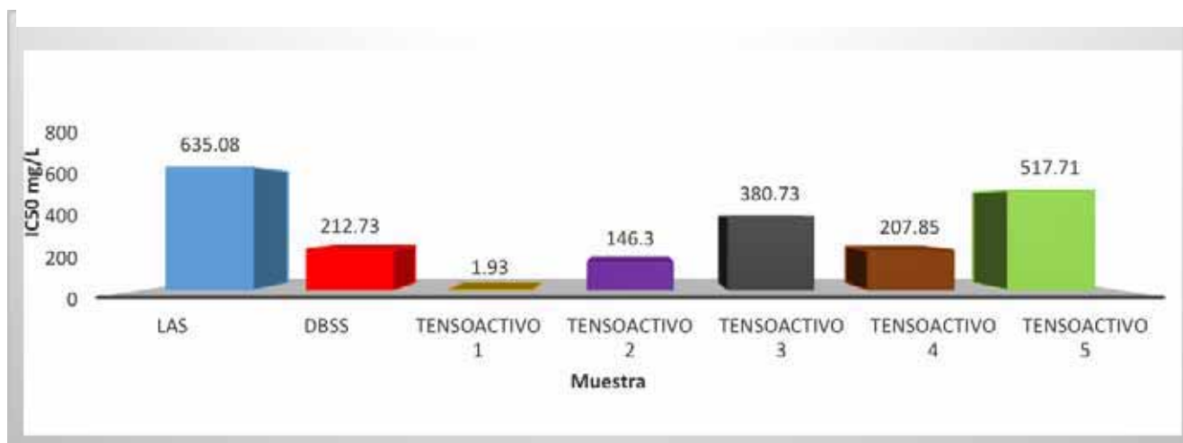
Gráfica 11. Resultados de IC50. LAS, DBSS y Tensioactivos 1-5 por por el método de respirometría en lodos activados
