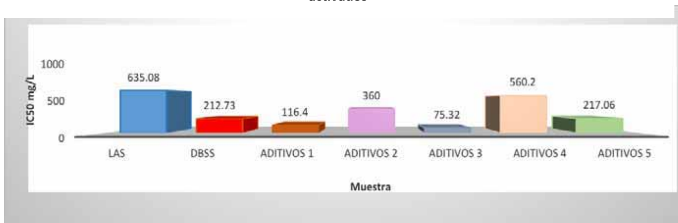
Gráfica 11. Resultados de IC50. LAS, DBSS y Tensioactivos 1-5 por por el método de respirometría en lodos activados
