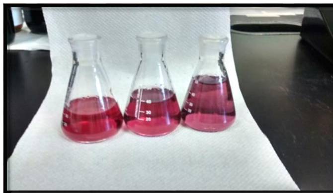
Figura 6.6 Determinación de nitrógeno inorgánico (titulación de la muestra destilada).
