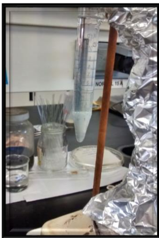
Figura 6.4 Determinación de la humedad por el método Dean-Starck.
