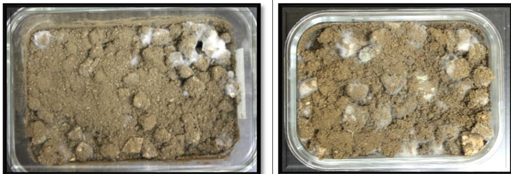
Figura 7.9 Biorreactores con suelo estéril y la cepa HBG, (A) en la primera semana del tratamiento, (B) en la semana 8 del tratamiento.
