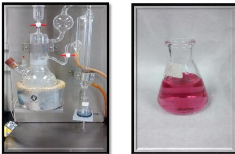
Figura 6.5 Determinación de nitrógeno total. (A) Destilación del digestado. (B) Destilado en el punto final de la titulación.
