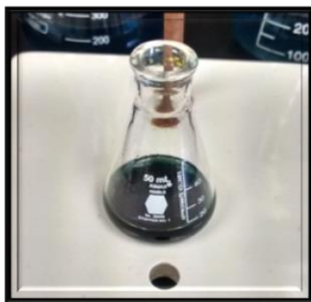
Figura 6.7 Punto final de la titulación para la determinación de la materia orgánica.
