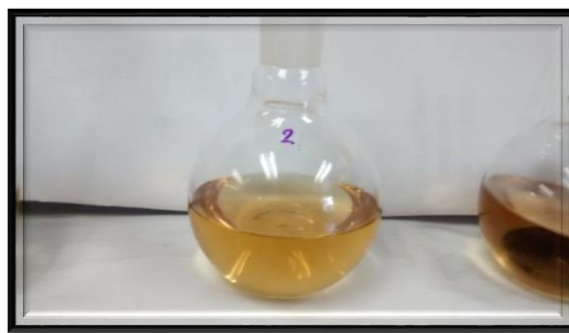
Figura 6.8 Extracción de los HTP del suelo.
