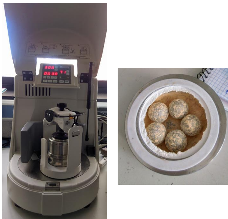
Figura 7.1. Molino planetario de bolas y vasija con bolas de acero inoxidable
