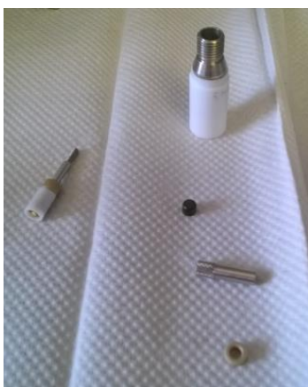
Figura 2.5. Piezas que conforman el dispositivo para montar el electrodo de trabajo de Carbón Vítreo .
