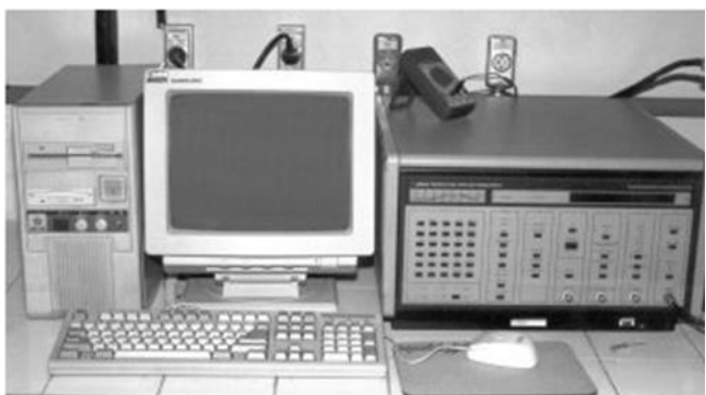
Figura 2.6. Potenciostatos galvanostatos utilizados para la realización de las técnicas electroquímicas. a) Potenciostato galvanostato PAR; b) Potenciostato galvanostato Versastat
