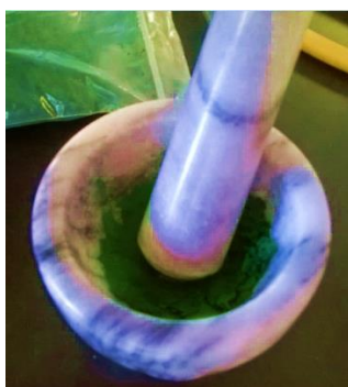
Figura 2.2. Fotografía del mortero para realizar la molienda de la sal de Cr(III)
