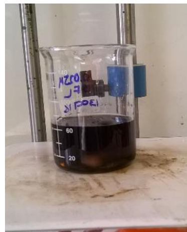
Figura 2.3. Preparación de la disolución de cromo. a) Con el DEP ChCl/Urea 1:2 b) Con el DEP ChCl/Etilenglicol .
