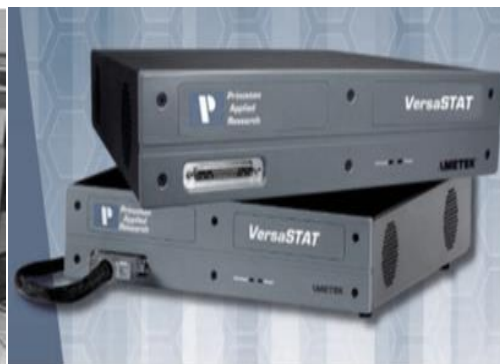
Figura 2.6. Potenciostatos galvanostatos utilizados para la realización de las técnicas electroquímicas. a) Potenciostato galvanostato PAR; b) Potenciostato galvanostato Versastat
