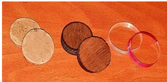
Figura 5.12. Foto de los materiales que se emplearon: Cartón Comprimido, Madera Balsa y Acrílico.
