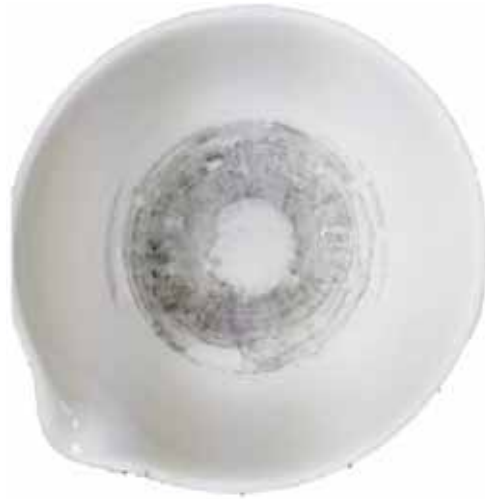
Figura 14. Evidencia de la alta concentración de sales
