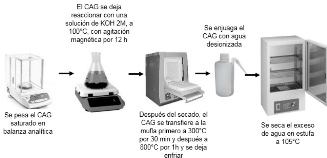
Figura 10. Proceso de regeneración usando Hidróxido de Potasio
