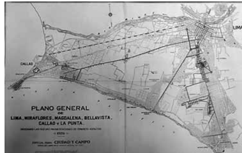
Figura 8. Plano general de calles asfaltadas con concreto en Lima y Callao para 1926. "Plano General de Lima Miraflores, Magdalena, Bellavista, Callao y La Punta indicando la nuevas pavimentaciones de concreto asfáltico, 1926". Revista Campo, ciudad y caminos , Núm. 23, noviembre de 1926, s/n.
