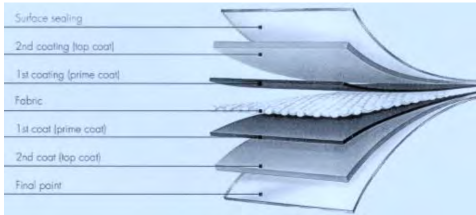
Figura 2.6. Partes de una membrana textil (adaptada de Forster y Mollaert 2004).
