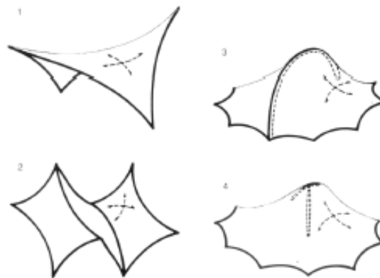
Figura 2.3. Algunos tipos de formas para Velarias. (adaptada de Forster y Mollaert 2004).
