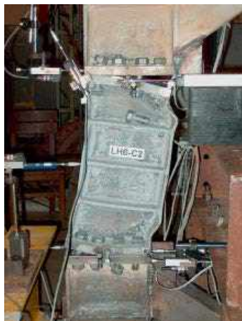
a) Falla en la conexión de una viga enlace de 500 mm de longitud
