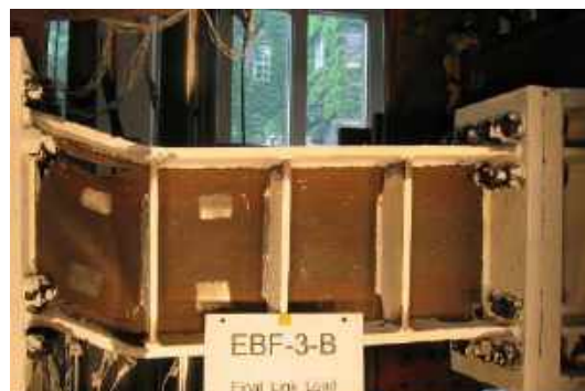
b) Viga enlace ensayada al final de la prueba (adaptada de Mansour et al. , 2008)
