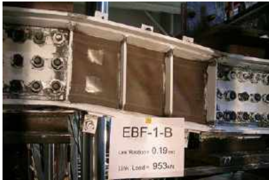
a) Viga enlace ensayada con un ángulo de rotación de 0.19 rad (adaptada de Mansour et al. , 2008)
