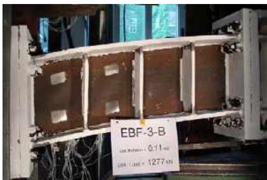
a) Viga enlace ensayada con un ángulo de rotación de 0.11 rad (adaptada de Mansour et al. , 2008)
