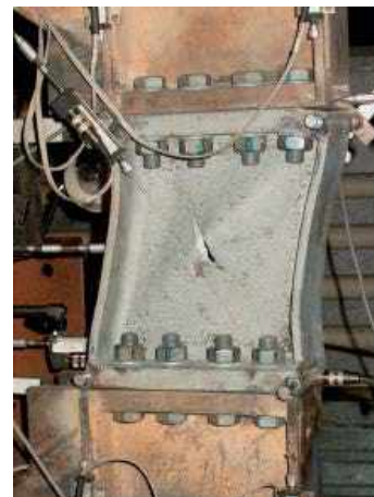
b) Fractura en el alma de la viga enlace con longitud de 300 mm
